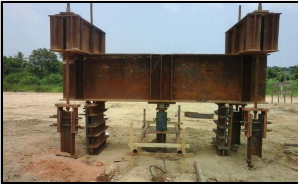
Figura 3.13 Estrutura de reação das provas de carga estáticas
