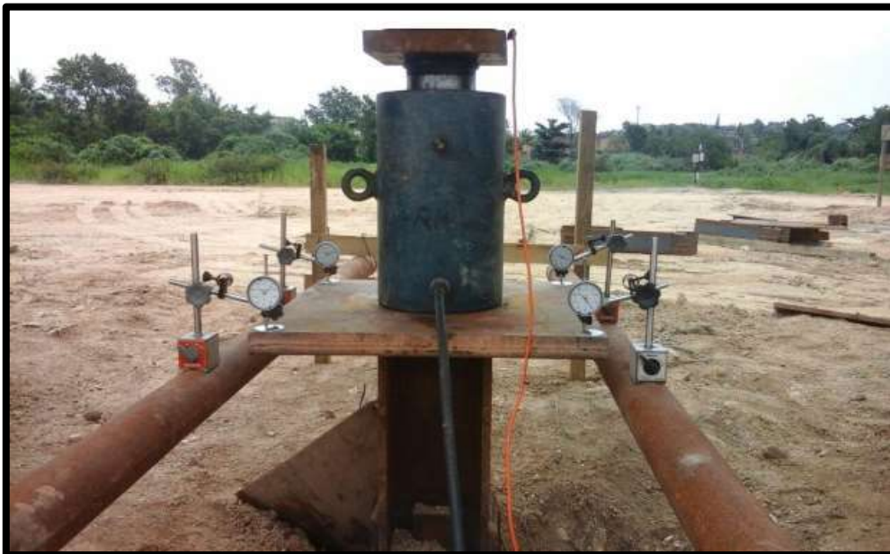
Figura 3.14 Sistema de medidas das provas de carga estáticas
