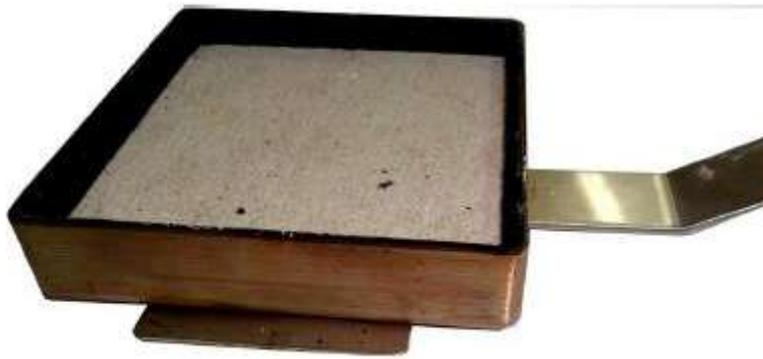
**Figura 3-6** - Imagem do suporte para amostra e massa de 100g para calibração da balança.
