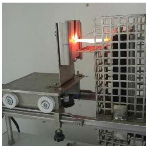
**Figura 4-25** – Ponta incandescente do equipamento em contato com a amostra com resina poliéster sem retardante de chamas.
