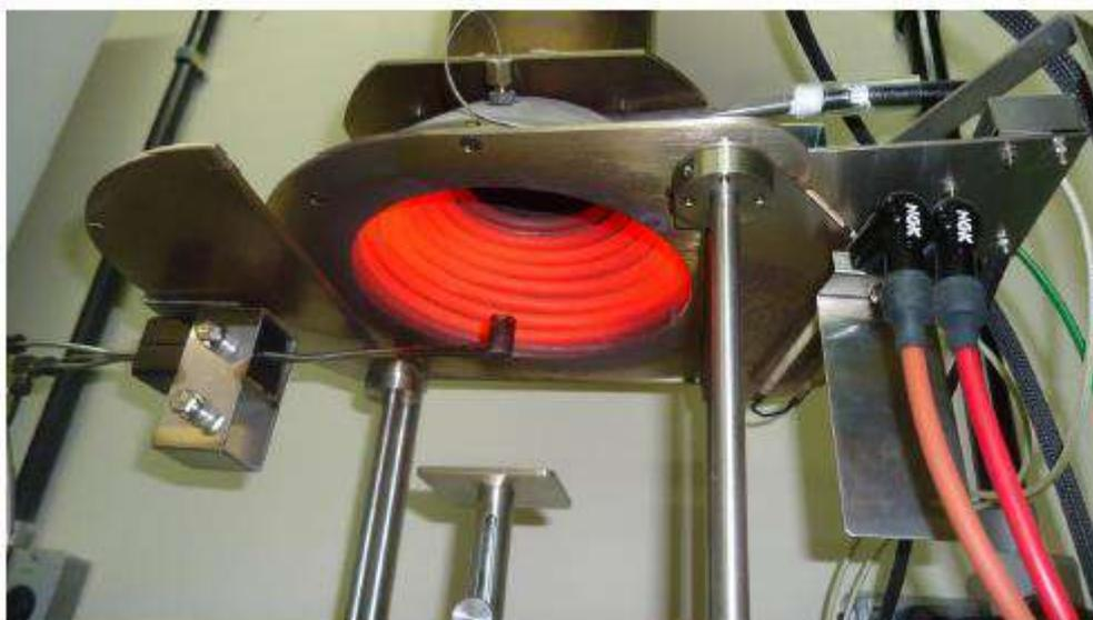
**Figura 3-7** - Imagem do medidor de fluxo de calor em uso.
