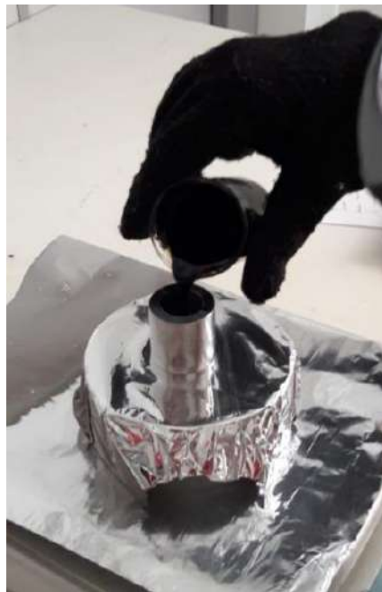
Figura 3.16 - Preparação da amostra para o ensaio de compressão axial do ligante.
