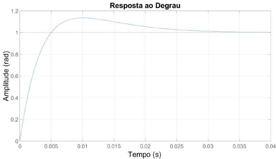
Figura 4.6: Resposta ao degrau do modelo de pequenos sinais do PLL.
