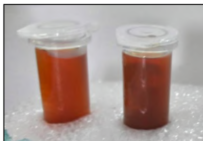
Figura 17: Sínteses em batelada de \text{Fe}_3\text{O}_4 . Reação de co-precipitação de \text{Fe}^{3+} e \text{Fe}^{2+} com base em proporção estequiométrica e sem completa remoção de \text{O}_2 das soluções.
