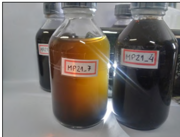
Figura 35: Foto de suspensões de nanopartículas de \text{Fe}_3\text{O}_4 armazenadas em atmosfera inerte ( \text{N}_2 ) 5 dias após a síntese. Verifica-se que a condição MP21_7 (Flux_7) apresentou maior instabilidade devido à decantação do produto.
