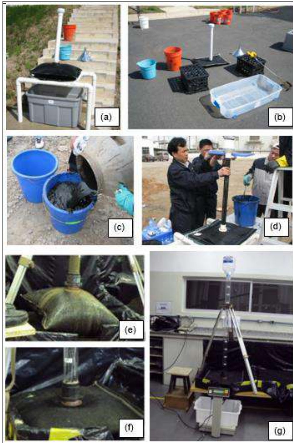
Figura 3.15 – Registros fotográficos de ensaios de bolsa de pequena dimensão: a) estrutura do ensaio, b) materiais utilizados, c) condicionamento da lama, d) enchimento manual, e) bolsa cheia, f) bolsa vazia, g) estrutura com tripé (adaptado de Yee et al., 2011; TenCate, 2010 e Tominaga, 2010)
