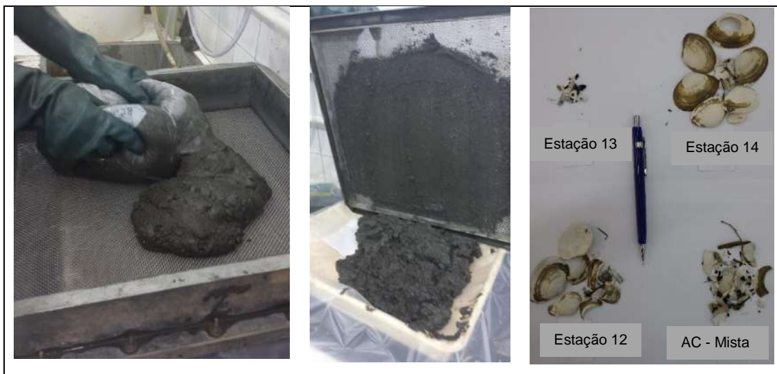
Figura 5.6 - Peneiramento das amostras na peneira n° 10 (# 2mm) e separação de conchas
