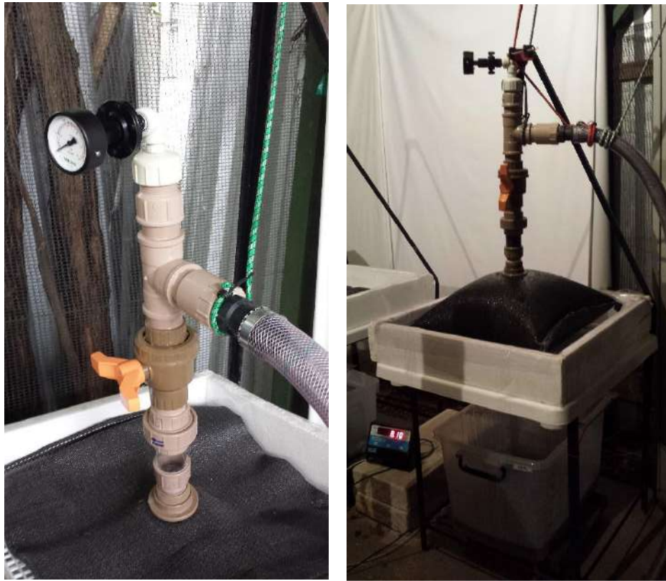
Figura 5.24 – Composição do sistema bombeado de enchimento de mini-SGF
