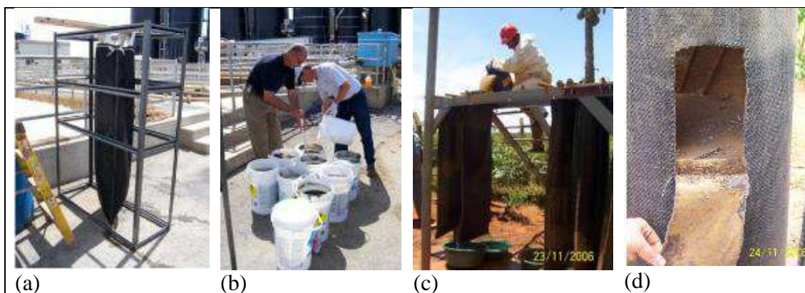
Figura 3.14 - Registros fotográficos de ensaios de bolsa suspensa: a) aparato de suporte, b) condicionamento da lama, c) enchimento da bolsa suspensa, d) abertura da bolsa suspensa (adaptado de Martins, 2006 e Mastin, Leebster e Salley, 2008).
