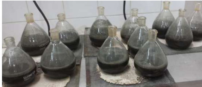
Figura 5.5 - Ensaio de determinação da massa específica dos grãos com picnômetros
