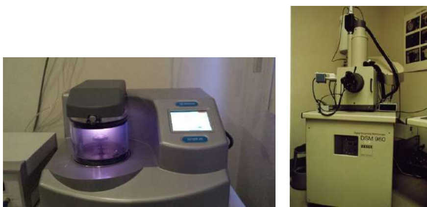
Figura 5.10 – Equipamento de metalização da amostra e Microscópio Eletrônico de Varredura
