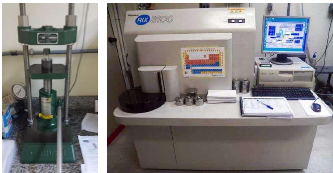
Figura 5.9 – Equipamento de moldagem das pastilhas e Espectrômetro por fluorescência de Raio-X, marca Rigaku, modelo RIX3100.
