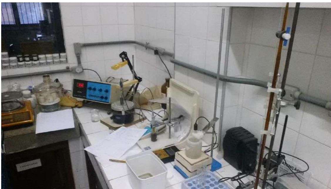
Figura 5.26 – Aparelhos de aferição do pH, CEE, Eh e temperatura do percolado no laboratório de química da geotecnia ambiental da Coppe/UFRJ
