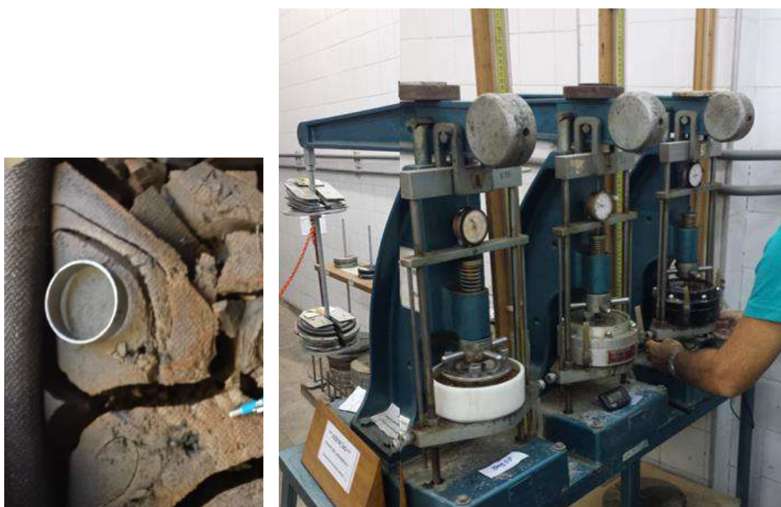
Figura 5.13 – Cravação de anel cilíndrico para obtenção do corpo de prova e Prensas de adensamento do tipo Bishop do laboratório de geotecnia da Coppe-UFRJ
