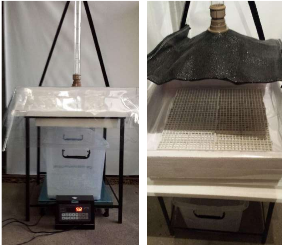
Figura 5.23 – Aparato em estrutura metálica e elementos constitutivos utilizados para desaguamento em mini-SGF com enchimento manual.
