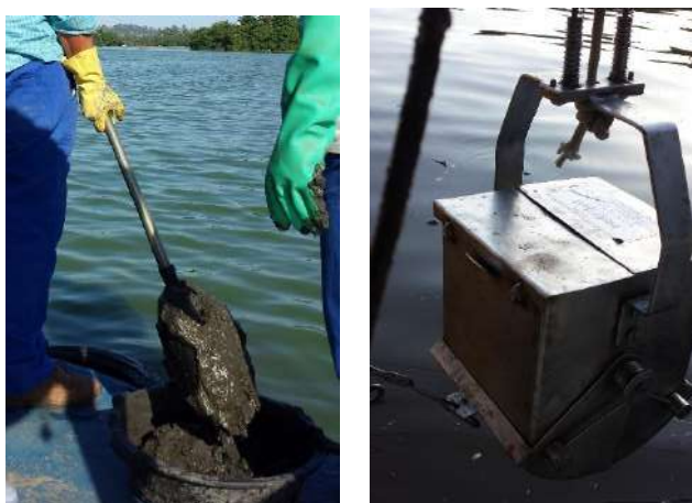
Figura 5.2 - Equipamentos de coleta do sedimento (Trado manual e pegador Ekman-Birge)
