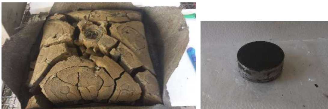
Figura 5.27 – Abertura da bolsa de pequena dimensão e amostra indeformada cilíndrica para ensaio oedométrico.
