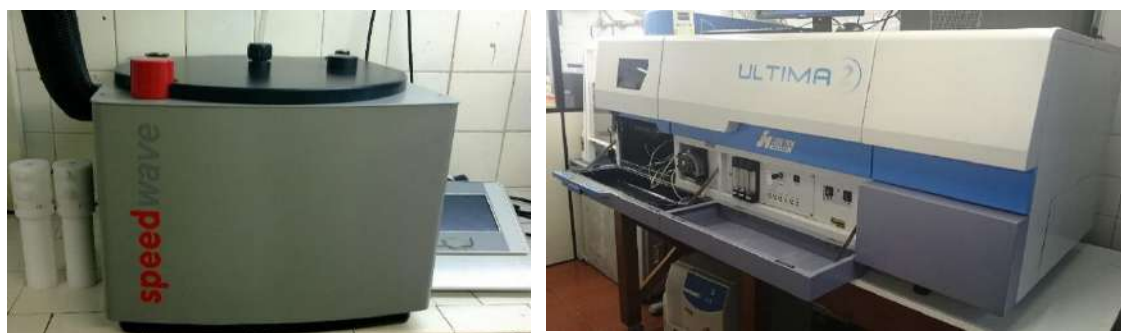
Figura 5.17 – Forno de micro-ondas da marca Berghof e Espectrômetro de Emissão Óptica com Fonte de Plasma Indutivamente Acoplado (ICP OES) da marca Horiba Jobin Yvon
