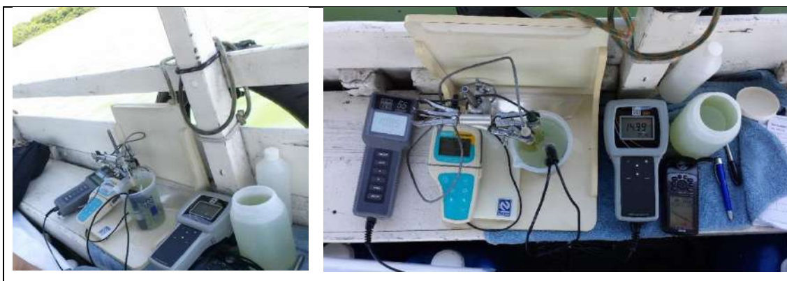
Figura 6.6 - Multiparâmetros para monitoramento da água nas duas campanhas de coleta
