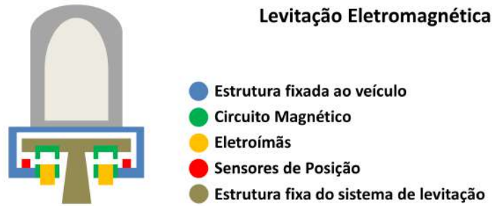
Figura 2.1: Modelo de Veículo Eletromagnético
