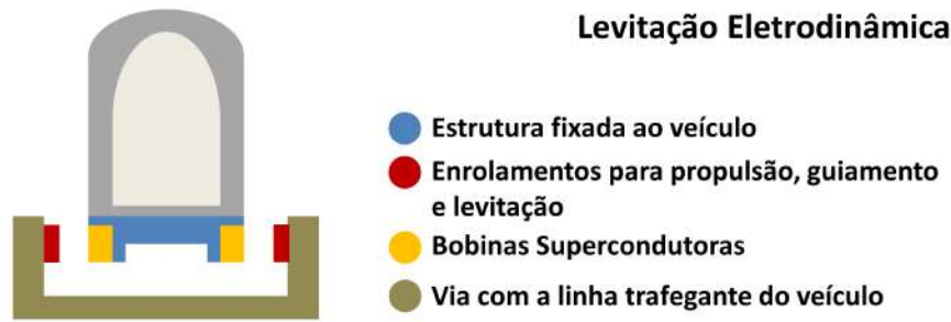
Figura 2.5: Modelo de trem de Levitação Eletrodinâmica.
