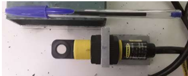
Figura 4.3: Sensor de Posição Ultrassônico S18UUAR
