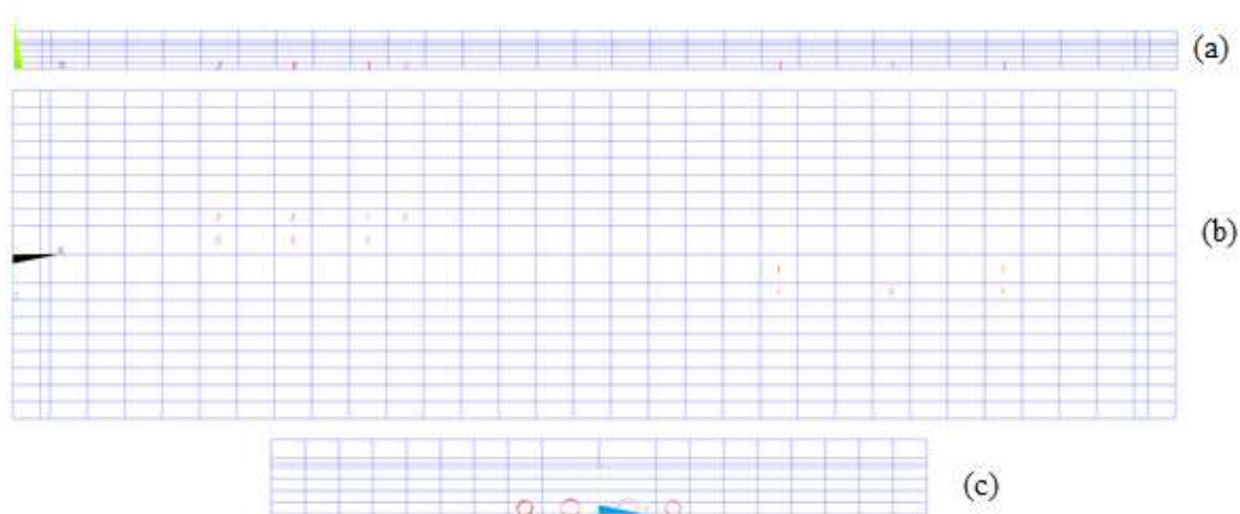
Figura 5.15: Formação de fissuras no modelo computacional – carregamento de 75 kN; vistas (a) lateral, (b) superior e (c) frontal.
