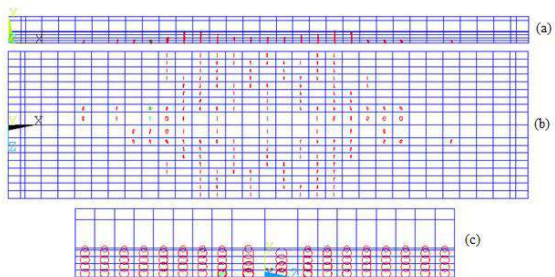
Figura 5.19: Formação de fissuras no modelo computacional – carregamento de 105 kN; vistas (a) lateral, (b) superior e (c) frontal.
