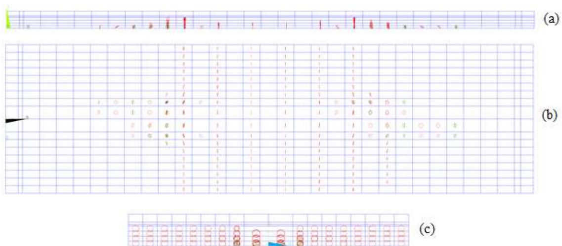
Figura 5.17: Formação de fissuras no modelo computacional – carregamento de 151 kN; vistas (a) lateral, (b) superior e (c) frontal.
