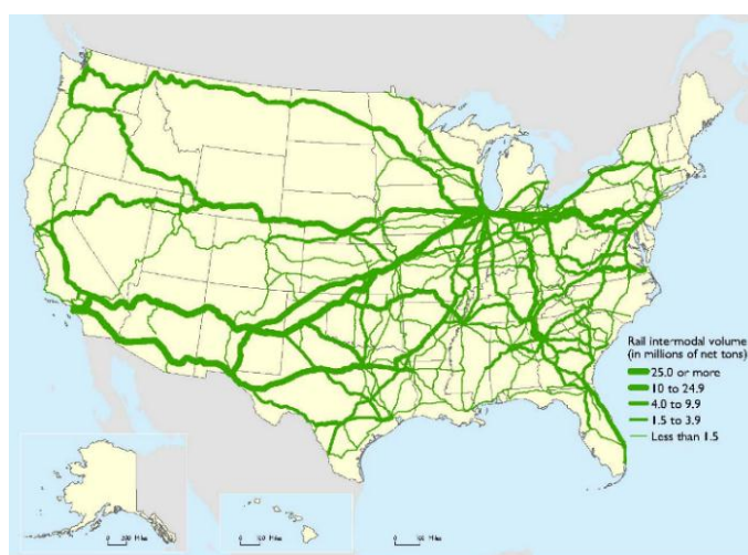
Figura 8 - Transporte intermodal ferro-rodovia (milhões de t) Fonte: Freight Facts and Figures – Bureau of Transportation Statistics - 2017
