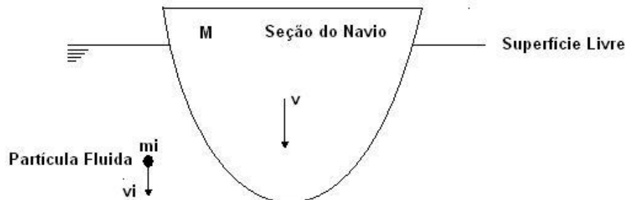
Figura 3.3: Movimento Vertical de Seção do Navio e Partícula Fluida
