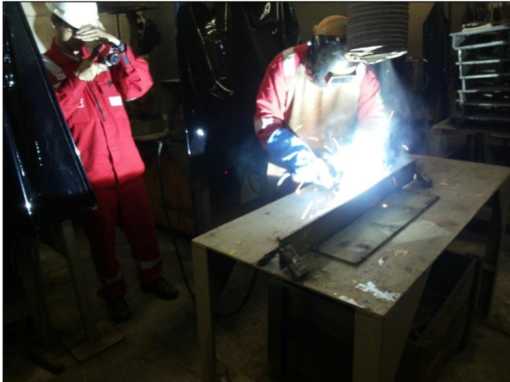
Figura 26 – Soldagens com acompanhamento e registro por câmera térmica.
