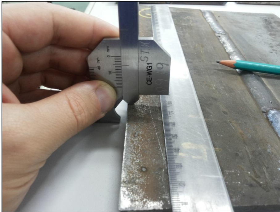
Figura 14 – Medição das deformações provocadas por cada técnica de soldagem. Uma das bordas da chapa foi presa longitudinalmente na bancada e na outra borda que estava livre foi medida a altura de afastamento da chapa à bancada.
