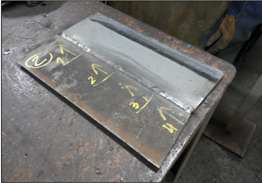
Figura 12 –Pós execução da solda passe à ré, onde o soldador promove a solda puxando o cordão de solda e parando para correr a mão. A marcação na foto indica onde começou a solda e seguindo a seta na sequência numérica.
