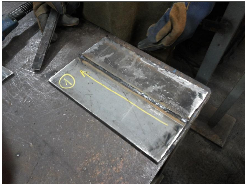
Figura 11 – Solda progressiva, onde o soldador promove a solda de forma contínua, sem parar
