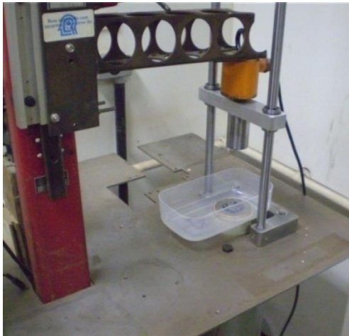
Figura 4.6 Célula de carga de impacto COPPE de 63 mm
