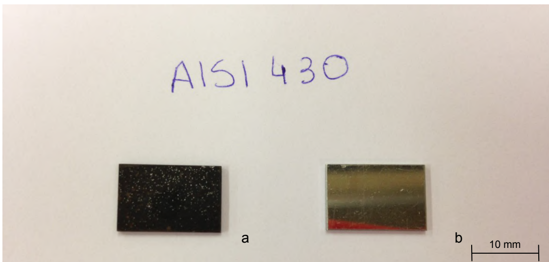
Figura 23 – Comparação de amostras do aço AISI 430 (a) envelhecida e (b) como recebida.
