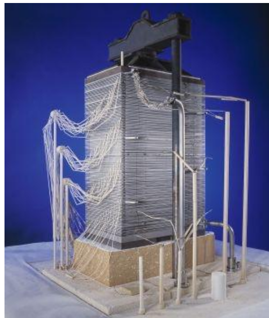
Figura 9 – Típico empilhamento de um Célula a Combustível de Óxido Sólido Planar. [3]
