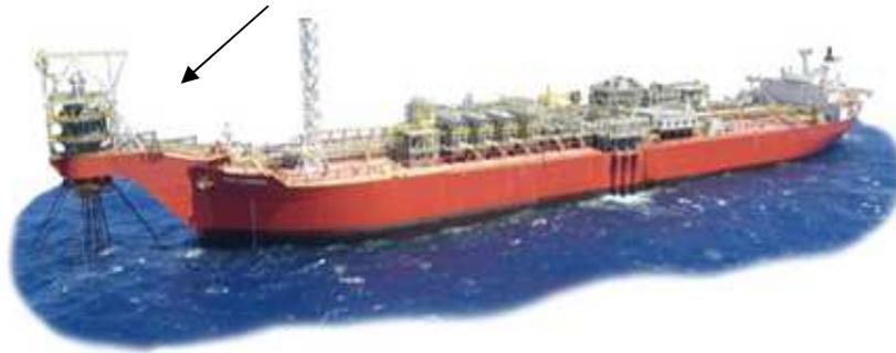
Spread – este sistema de amarração consiste em linhas de ancoragem distribuídas em torno do costado. Desta forma, as ondas incidem em várias direções.
