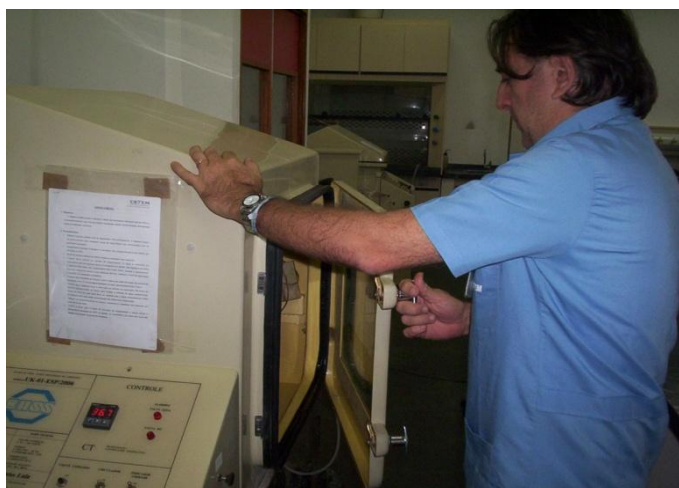
Figura 25. Exposição dos corpos de prova à ação de SO 2 .
