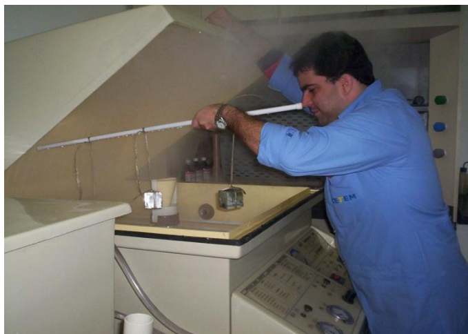
Figura 24. Exposição das amostras à câmara de salinidade.
