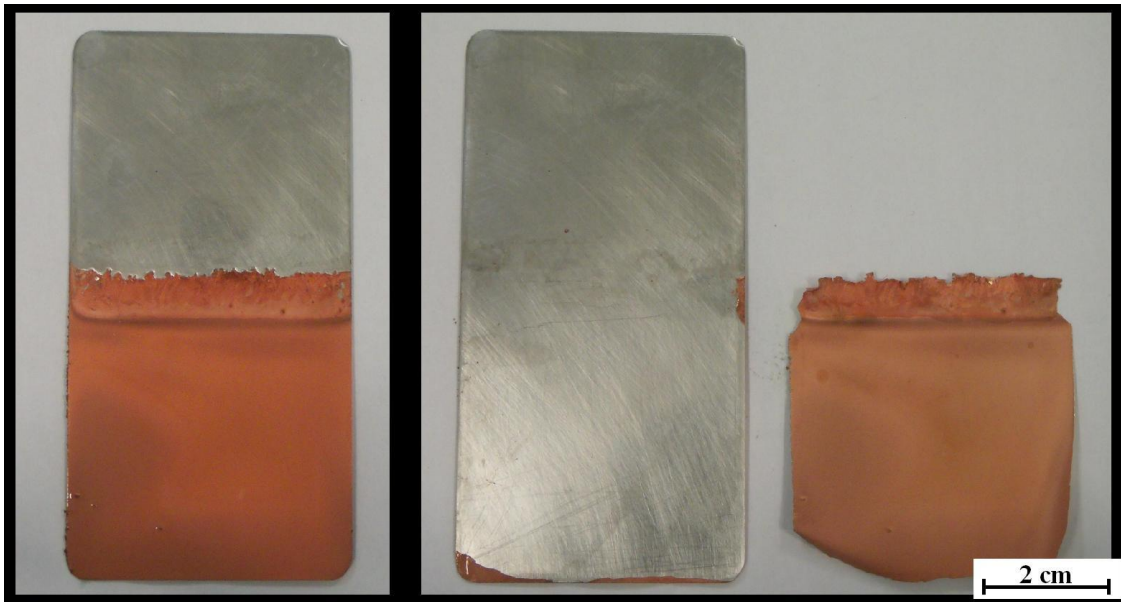
Figura 6 - Aspecto da chapa de aço inox com o depósito de cobre antes e depois de ser removido.
