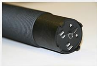
Figura 6: Sonda Kapta com detalhe para os sensores (condutividade, cloro ativo, pressão e temperatura)
