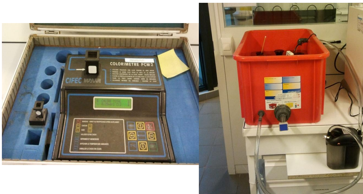
Figura 16: Colorímetro utilizado nas medições, à esquerda, e sistema para aquecimento da água e estabilização da temperatura, à direita, nos testes de decaimento do cloro.
