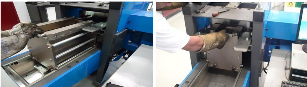
*Figura 29a e 29b - Colocação do molde no PResBOX*
