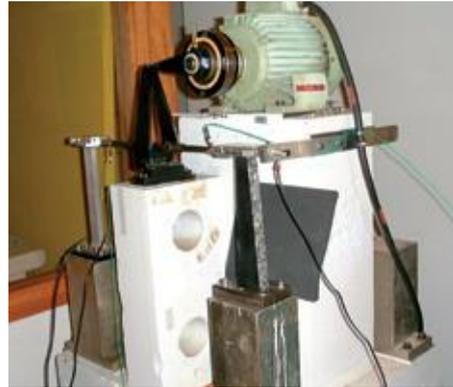
*Figura 7 - Flexão de Corpos de Prova Trapezoidais*
