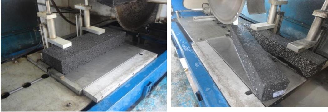
*Figuras 34a e 34b - Serragem da metade do prisma*
