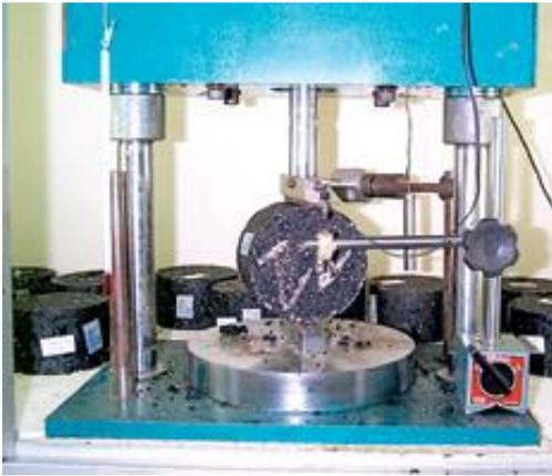
*Figura 6 - Compressão Diametral de Corpos de Prova Cilíndricos*
