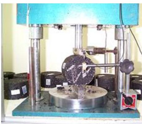
Figura 5- Ensaio Tradicional de Vida de Fadiga por Compressão Diametral
