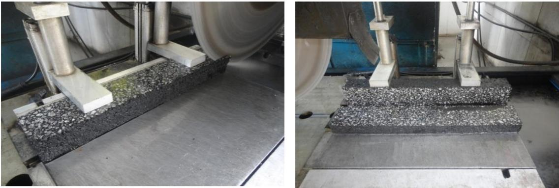
*Figuras 35a e 35b - Serragem da vigota para que fique nas dimensões adequadas*
