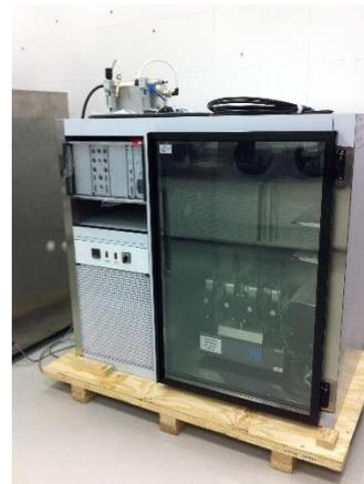
Figura 11b – Dispositivo para Ensaio de Flexão em Quatro Pontos na Câmara de Controle de Temperatura
