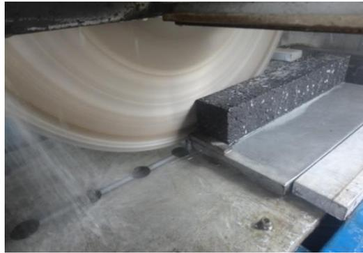
*Figura 34c - Prisma serrado*
