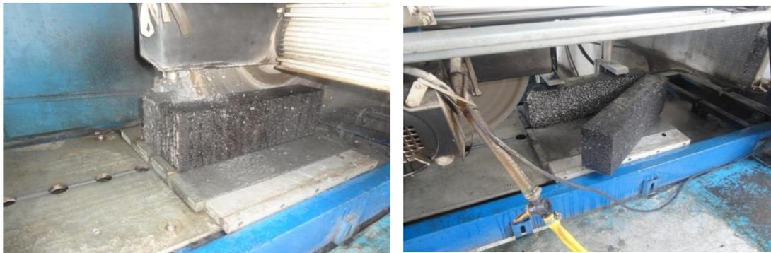
*Figura 33a e 33b – Serragem do prisma em dois pedaços iguais*
