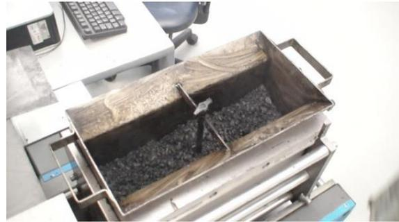
*Figura 26 - Massa dentro do molde com o quarteador*
