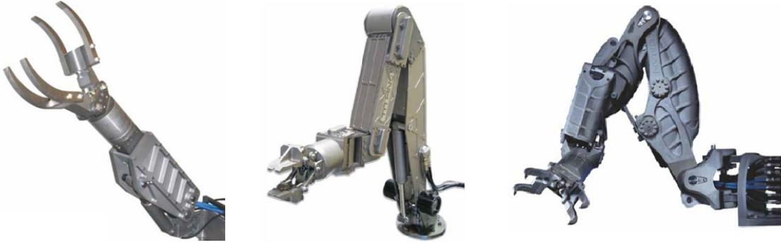
Figura 2.5: Exemplos de manipuladores. Manipulador de cinco funções (esquerda) e manipuladores de sete funções (centro e direita).
