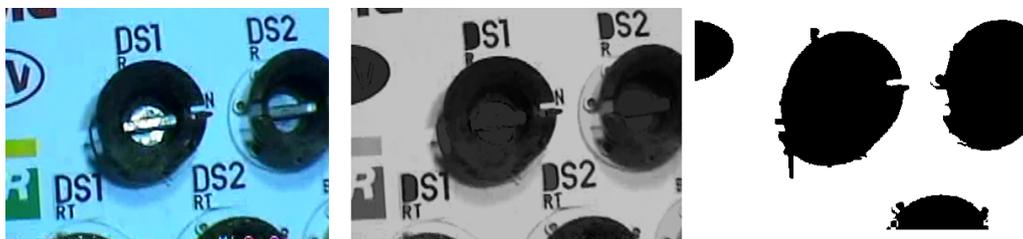
Figura 5.14: Processamento de imagem em proximidade.
