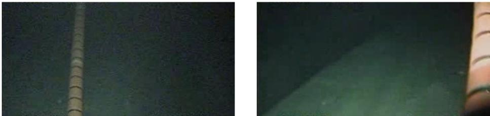
Figura 2.19: Partes inaceitáveis da inspeção com duto distante ou não enquadrado.
