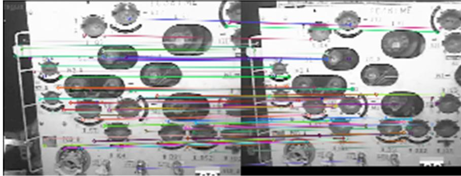
Figura 4.5: Rastreamento de pontos após movimento do ROV a distância.
