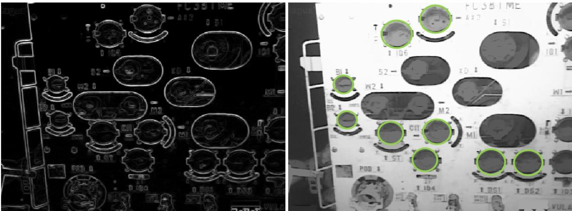
Figura 4.10: Detecção de círculos em bordas de interfaces.
