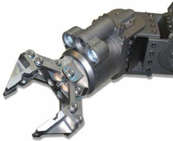
Figura 2.12: Câmera de punho para manipulador de sete funções.
