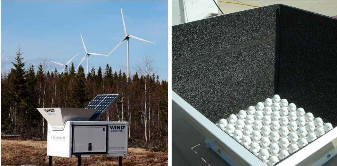
Figura 8 – Estrutura externa de um sistema SODAR utilizado no monitoramento do potencial eólico (esquerda) e o instrumento em detalhe localizado em seu interior (direita).
