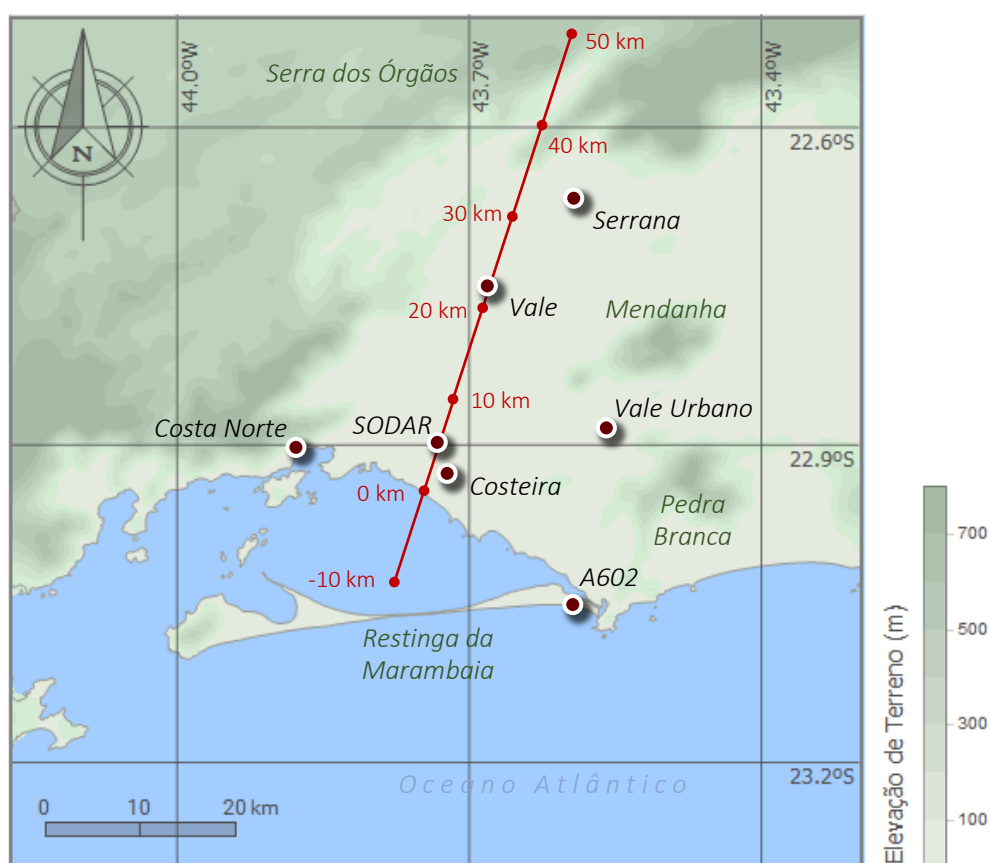
Figura 42 – Domínio 5 das simulações WRF com destaque para o corte transversal à linha de costa (linha vermelha) selecionado para análise da estrutura vertical da brisa. A linha possui 60 km de extensão (10 km sobre a Baía de Sepetiba) e alinha o SODAR e a estação Vale.
