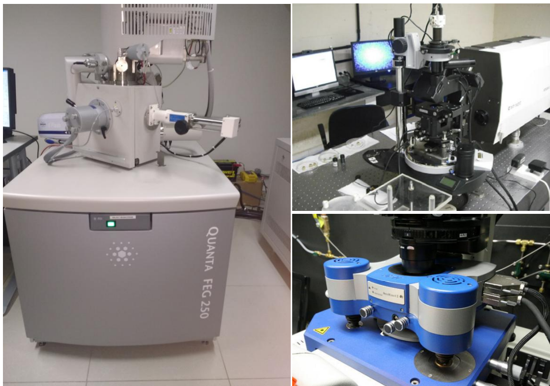
Figura 3.8 - Equipamentos utilizados para a caracterização das superfícies após os ensaios: (a) microscópio de varredura eletrônica (MEV-FEG); (b) espectrômetro Raman; (c) microscópio de força atômica (AFM).
