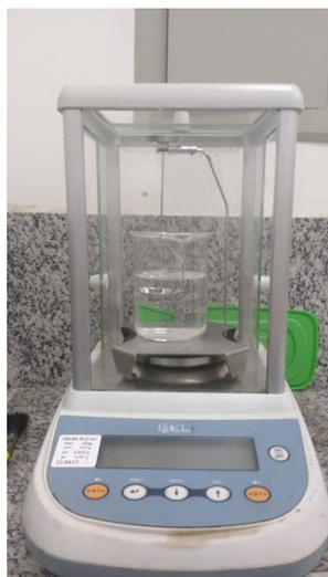
Figura 5.6: Aparato para medição da porosidade aparente
