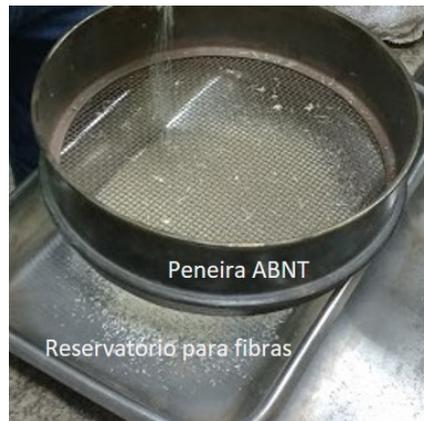
Figura 4.5: Peneiramento das fibras de sisal
