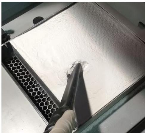
Figura 2.6: Remoção do pó não aglomerado com auxílio do aspirador.
