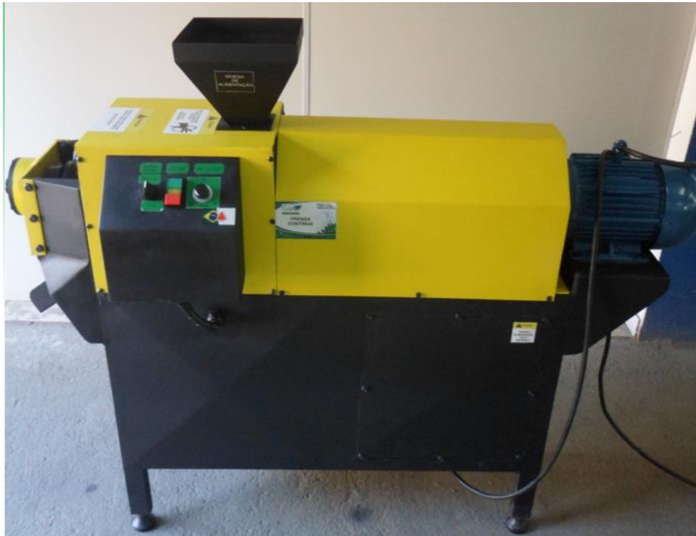
Figura 3: Prensa para extração de óleos em sementes oleaginosas
