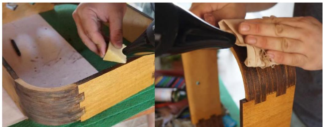
Figura 61 Aplicação de cera de carnaúba, para proteção da peça.
