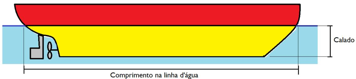
Figura A.2: Dimensões do casco (vista lateral)
