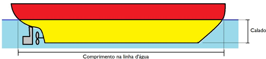
Figura 4.10: Principais dimensões de um navio
