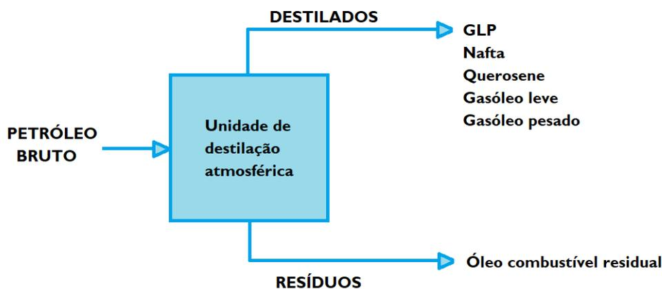
Figura 2.6: Esquema simplificado de refinaria *straight-run*
