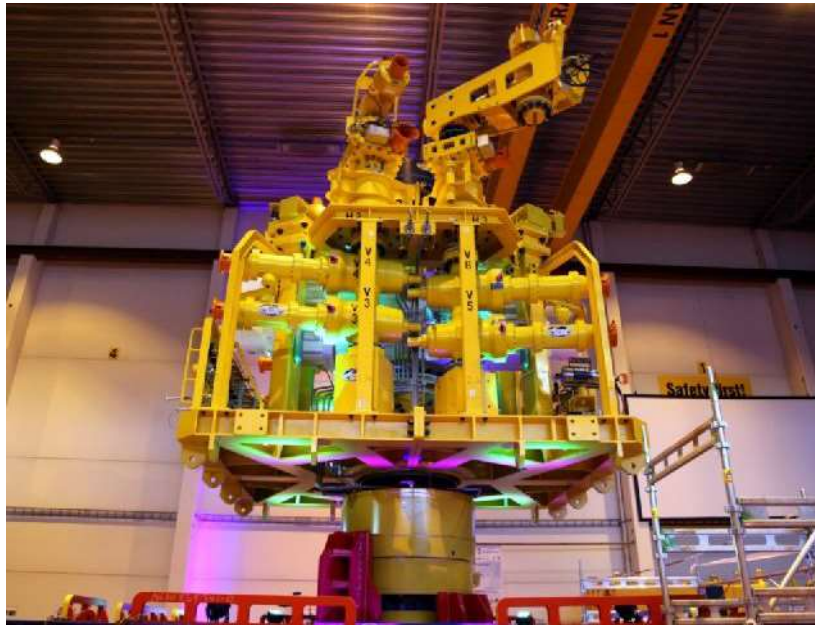
Figura 15 - Capping Stack System (CCS) de propriedade da OSRL.
