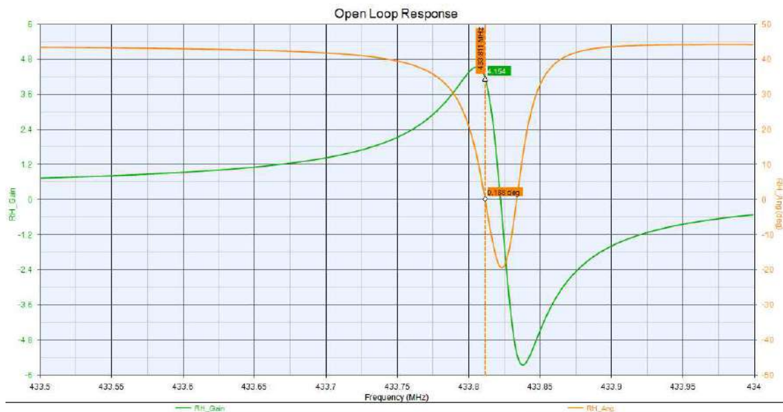
Figura 3.8: Gráfico de ganho em malha aberta do circuito Colpitts de base comum em relação à frequência com resistência equivalente série (ESR) de 100\Omega .
