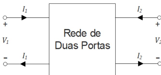
Figura 2.1: Rede de duas portas: convenções de sinais [57].
