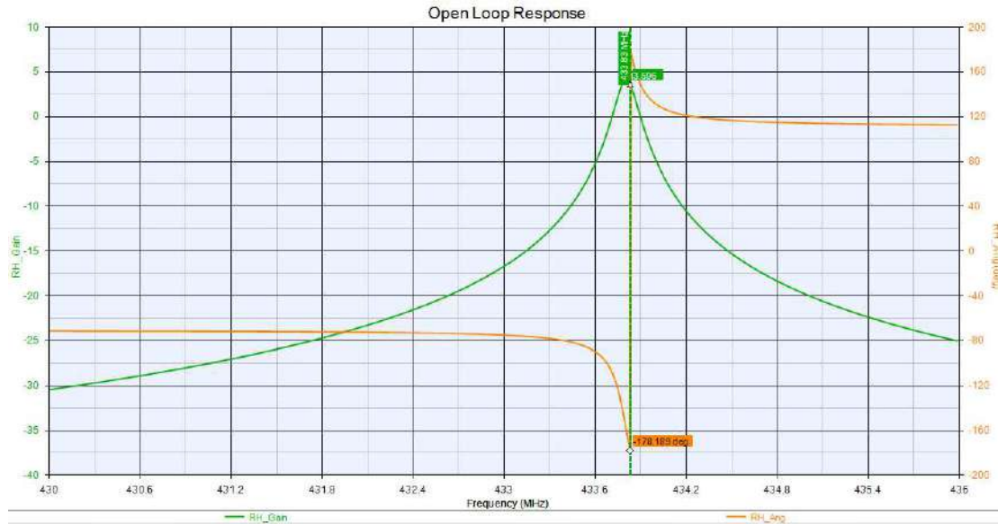
Figura 3.13: Gráfico de ganho do circuito Colpitts ressonante série em relação à frequência.
