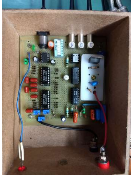
Figura 3.10: Montagem do circuito controlador de tensão e para amostragem de saída.
