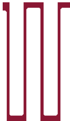
Figura 2.4: Exemplo de estrutura básica para molas usada nas impressões 3D, sendo uma aproximação do que se usa em MEMS.
