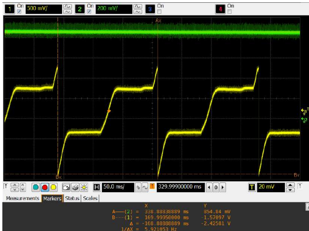
Figura 5.20: Resultado experimental para tensão de 260 V entre as placas para o Unipolar de 3 Estágios. Para o sinal em amarelo, cada 500 mV exibido correspondem à 50 V de tensão real medida.
