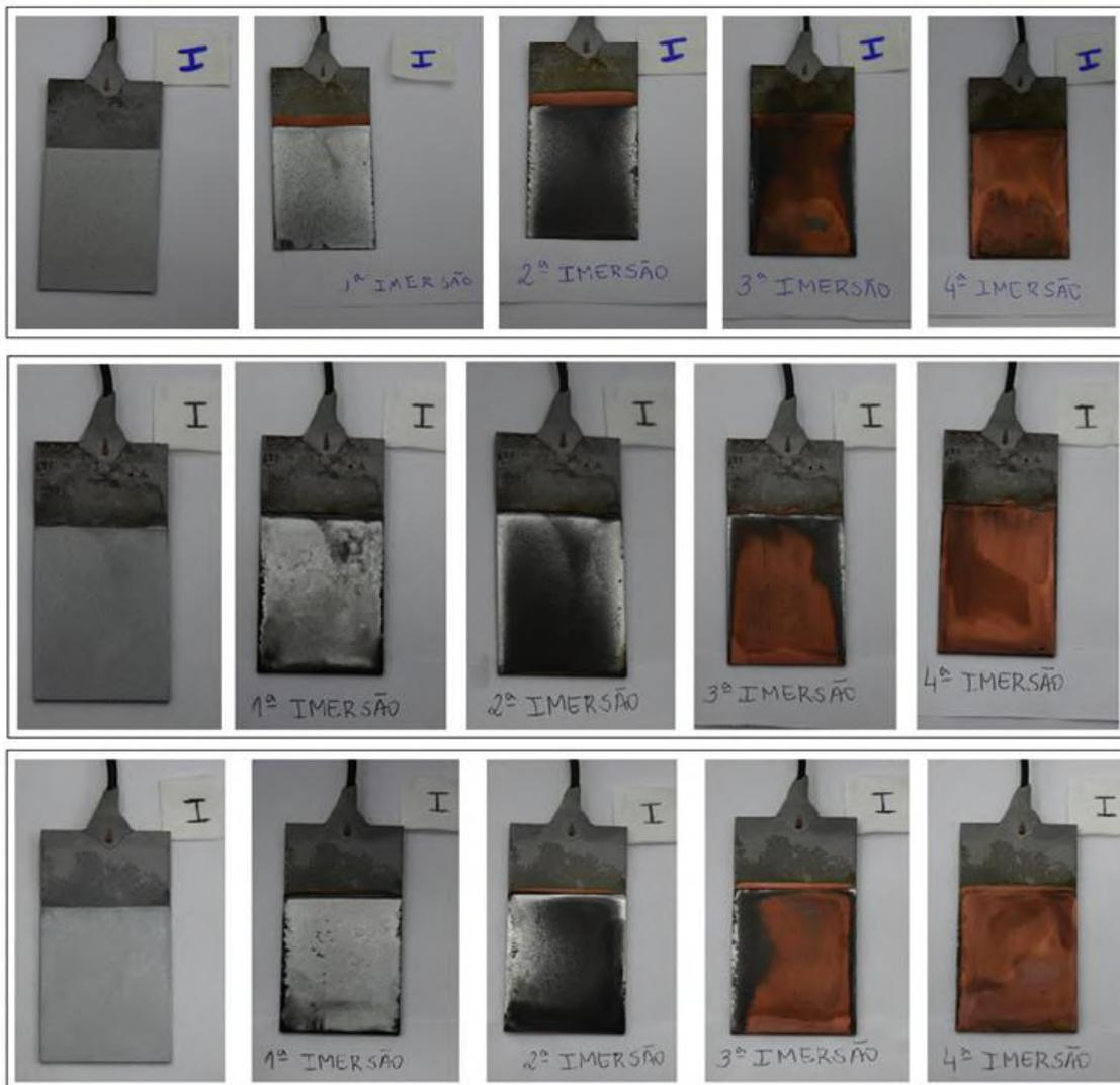
Figura 13: Triplicatas do ensaio de uniformidade do corpo de prova eletrodepositado com lixiviado.
