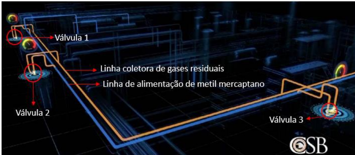
Figura 10 – Alinhamentos da tubulação de alimentação de metil mercaptano, de gases residuais e as válvulas de alívio. Modificado de CSB, 2016.
