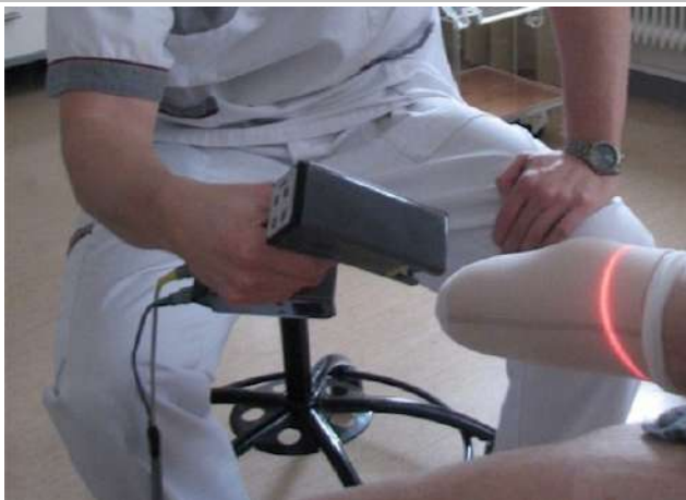
Figura 16: Escaneamento do coto para extração do modelo virtual.
