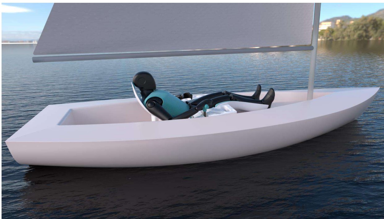
Figura 199. Configuração do encosto para atender usuário do percentil 95% masculino
