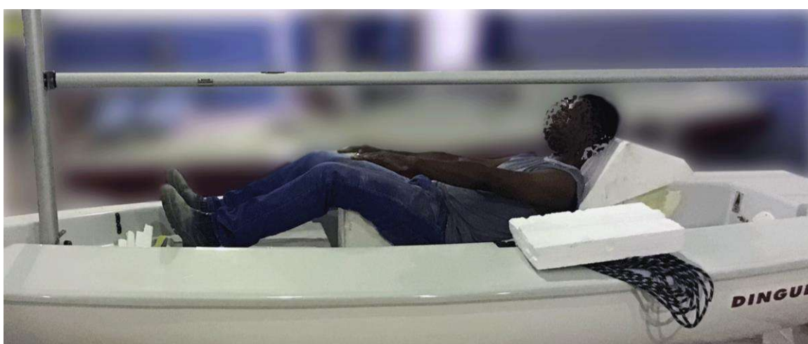
Figura 69. Teste de postura no segundo modelo. Percentil 95% masculino.
