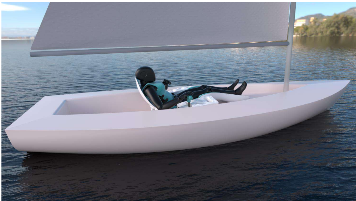
Figura 198. Configuração do encosto para atender usuário do percentil 5% feminino.
