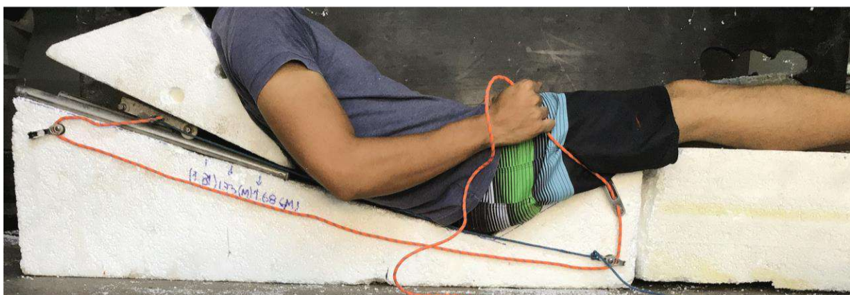
Figura 98. Teste de sistema para regulagem do assento.
