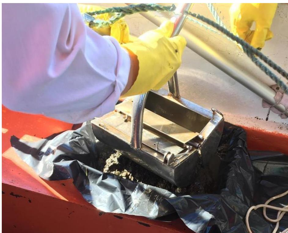
Figura 4 - Draga do tipo Van Veen utilizada na coleta dos sedimentos.
