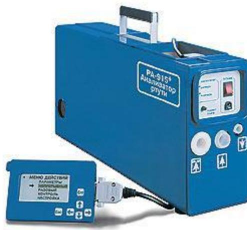
Figura 7 - LUMEX, absorção atômica acoplada a pirólise utilizada na análise de Hg.
