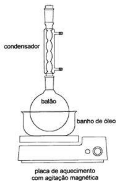
Figura 19 – Representação esquemática do reator utilizado no processo de funcionalização da sílica.
