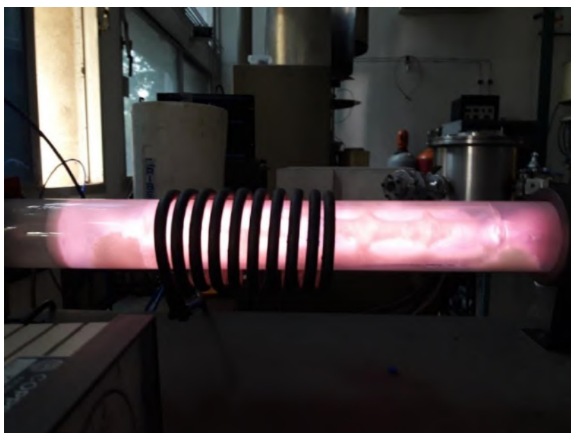
Figura 22 – Equipamento de plasma durante o processo de funcionalização.
