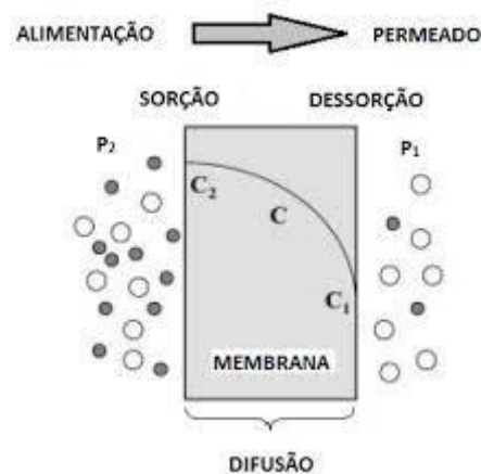
Figura 9 – Representação esquemática do mecanismo de sorção-difusão em membranas densas (Adaptado de PEISINO, 2009).
