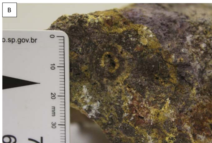
Figura 20 – A) Amostra de mão utilizada para a caracterização macroscópica do nível ferruginoso basal; B) em detalhe, feições circulares associadas à ferruginização.
