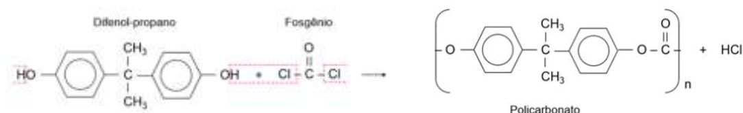
Figura 3.3: Reação de Formação de Policarbonato à partir de cloreto de carbonila e BFA. Fonte: (NAHRA, 2018)
