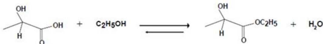
Figura 26 - - Reação de esterificação para formação de lactato de etila.
