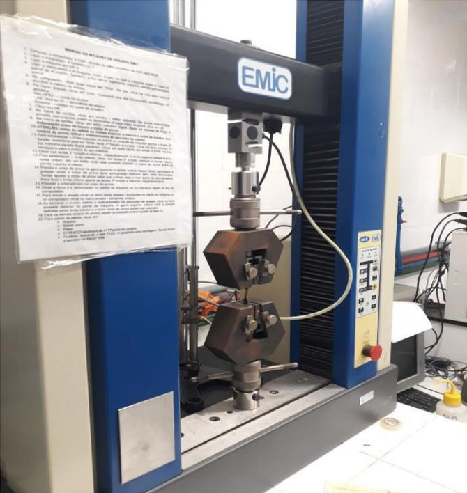
**Figura 22 – Dinamômetro EMIC onde os ensaios de tração foram realizados.
