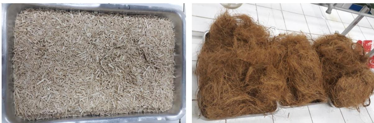
**Figura 19 – Fibras de bagaço de cana-de-açúcar (à esquerda) e de coco (à direita) após a secagem em estufa.**
