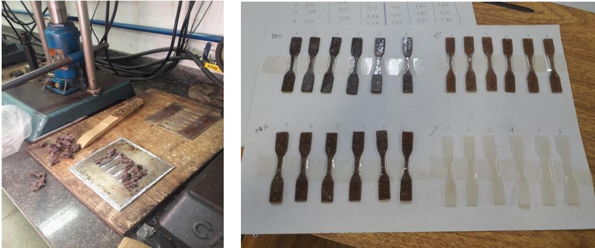
**Figura 21 – Preparo da mistura no molde para prensagem em prensa hidráulica de bancada (à esquerda) e corpos de prova obtidos a partir dos compostos após prensagem (à direita).
