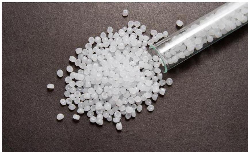
**Figura 1 – Polietileno comercial na forma de pellets.**
