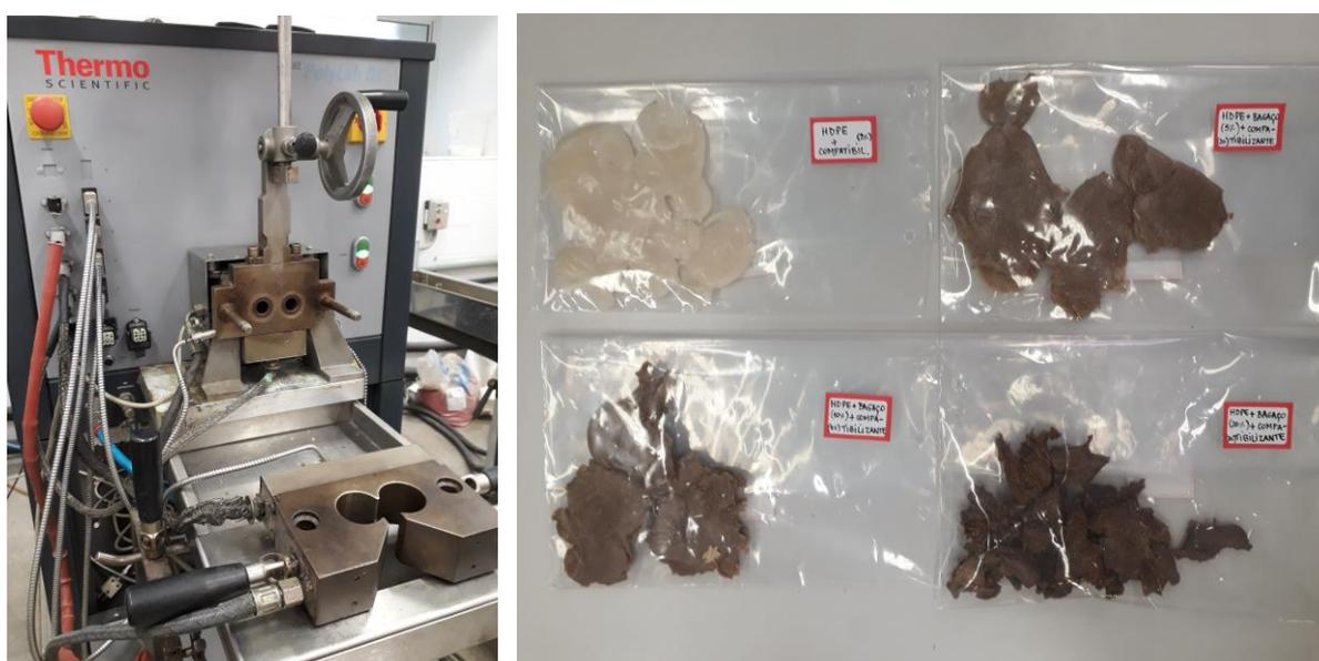
Figura 20 – Misturador Haake (à esquerda) e PE/compatibilizante e compósitos obtidos para PEAD/bagaço nas diferentes proporções de fibra (à direita). Fonte: Autoria própria.
