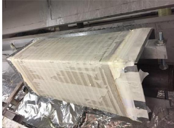
(b) Estado final da caixa de compósito após ciclo térmico.
