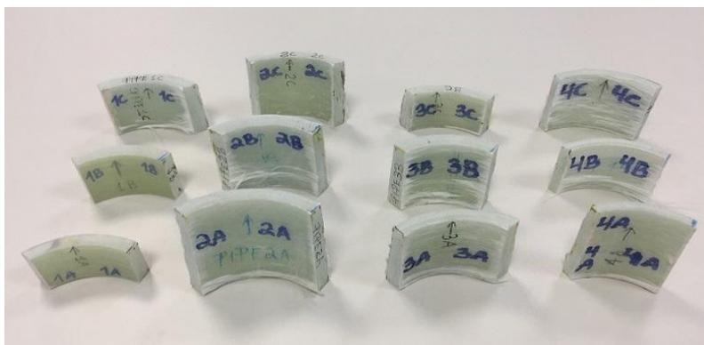
Figura 8.9: Amostras para avaliação micrográfica.
