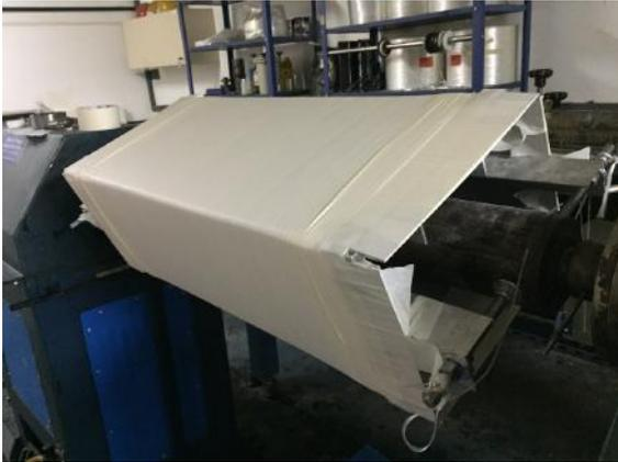
(a) Caixa de compósito envelopada após o processo de enrolamento filamentar.
