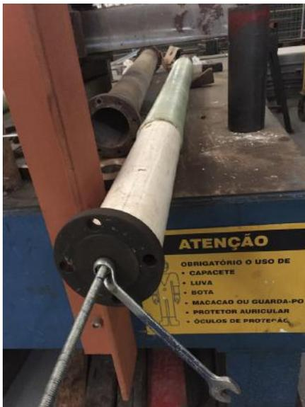
(b) Desmoldagem utilizando um batente de PVC e tração auxiliada por uma barra roscada.
