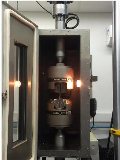
Figura 8.31: Primeira Tentativa de ensaio de compressão - usando garras de tração.
