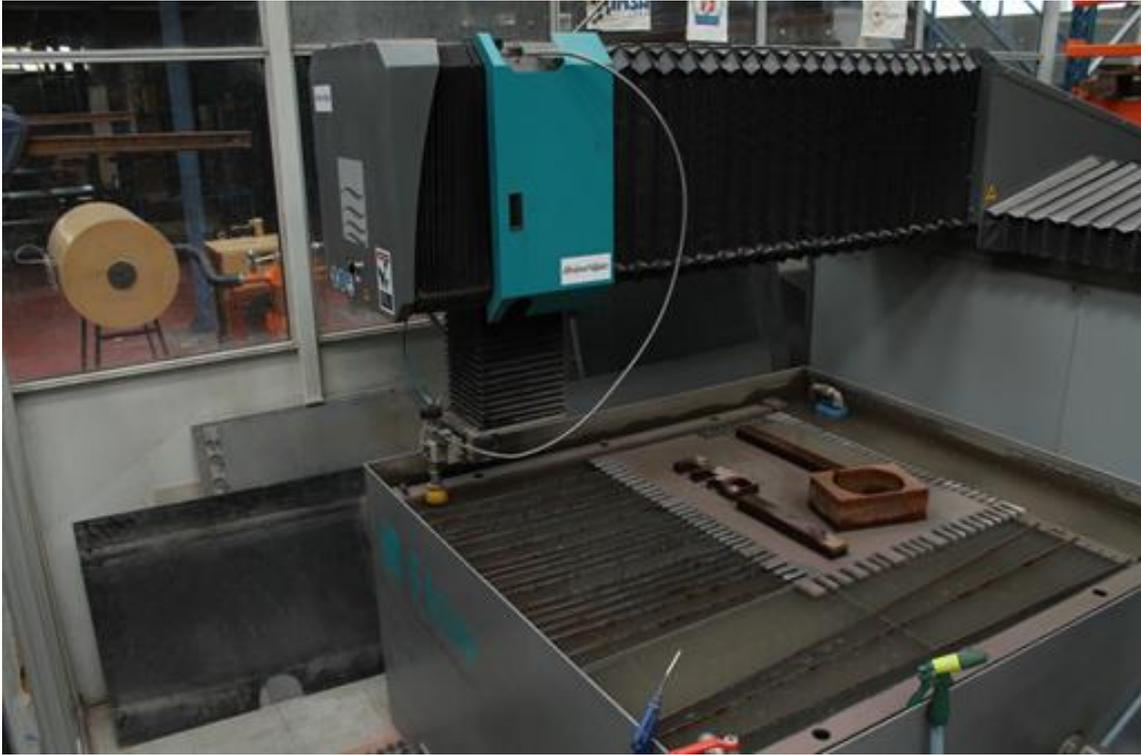
(a) Equipamento de corte por jato d'água.
