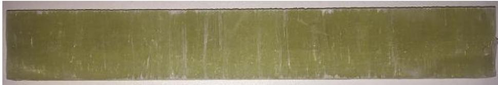
Figura 7.21: Corpos de prova de tração com e sem abas.
