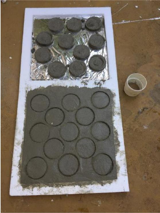
(a) Processo de fabricação dos centralizadores de concreto.
