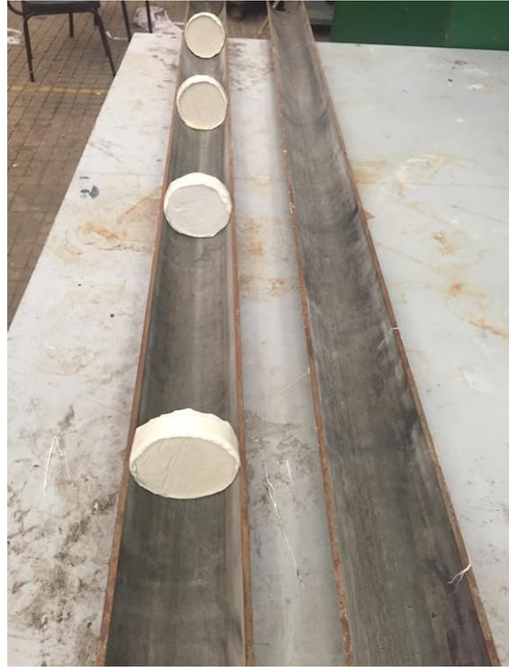
(b) Fixação dos centralizadores de concreto no interior do mandril bipartido.
