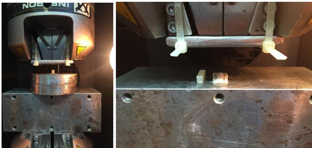
(a) Contentor de flambagem. (b) Amostras em mini-blocos com seção quadrada.
