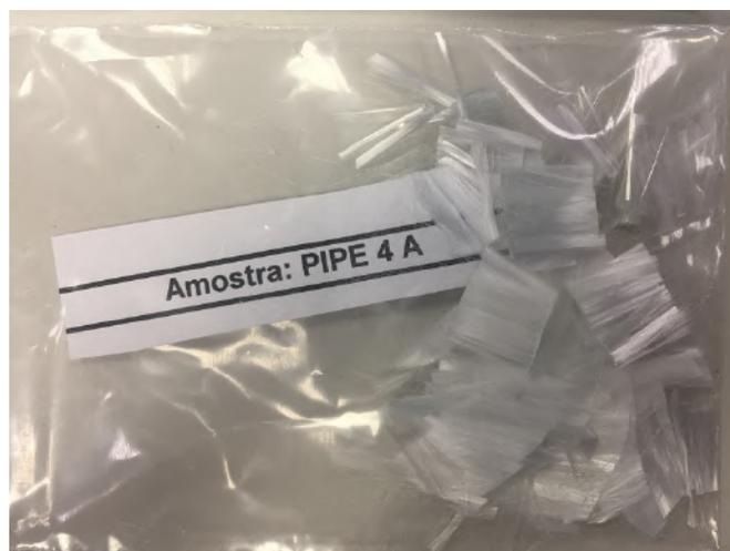
Figura 8.7: Resíduos após calcinação da amostra do Pipe-4A.
