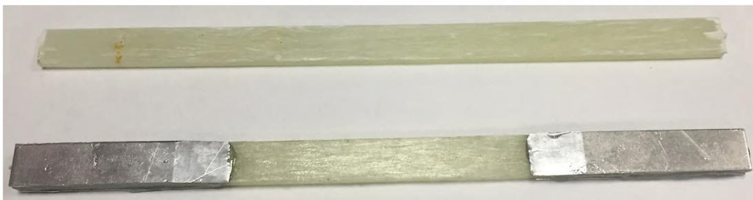
Figura 7.20: Corpos de prova de tração com e sem abas.
