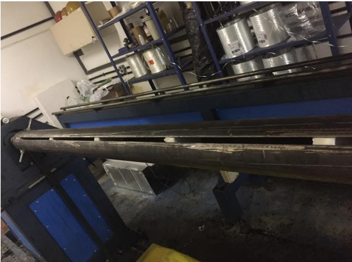
(c) Mandril com quatro centralizadores instalados.
