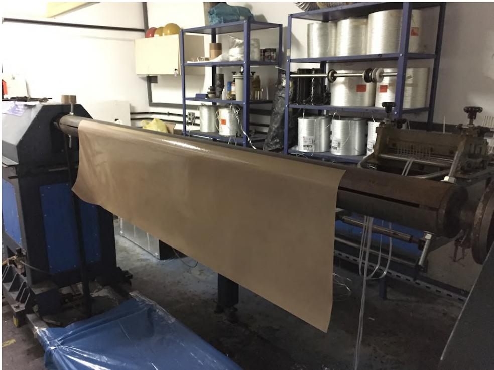
Figura 7.1: Processo de preparação da superfície do mandril bipartido para a produção do primeiro tubo (Pipe 1A).
