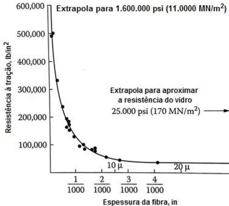
Figura 2.6: Relação entre tensão última e diâmetro da fibra [8].
