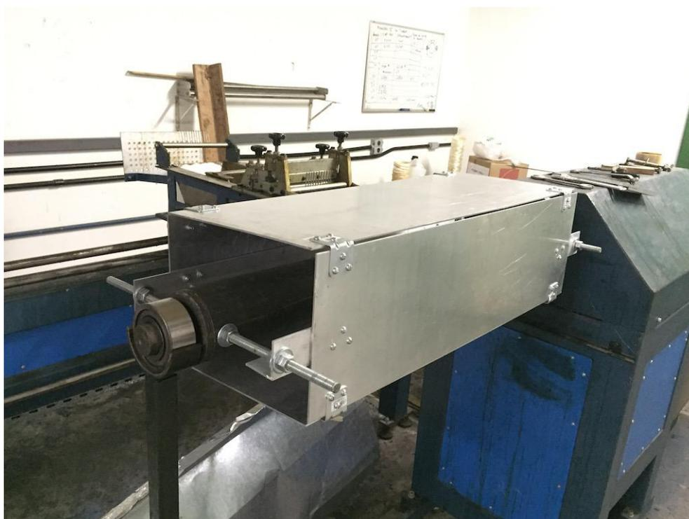
Figura 7.11: Perfil quadrado construído para a produção de placas planas para extração de corpos de provas de caracterização de material.
