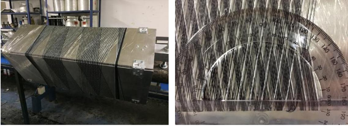
(a) Teste de produção de perfil retangular usando enrolamento com linhas de costura. (b) Verificação dos ângulos obtidos no processo de enrolamento do perfil retangular.
