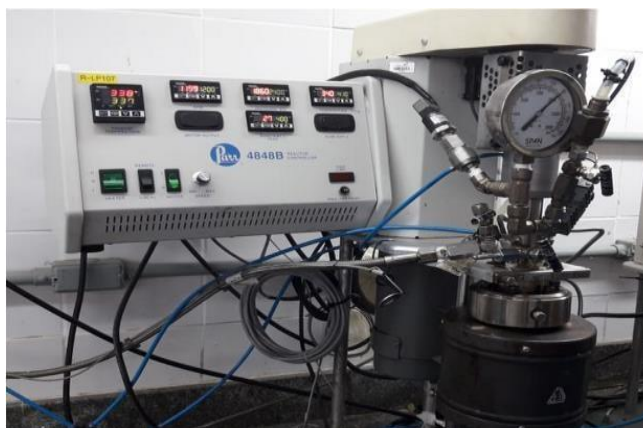
Figura 22 - Reator Parr utilizado no hidroprocessamento do óleo bruto de microalga (Fonte: Gonçalves, Jussara A, 2007)
