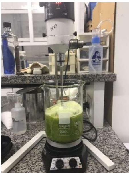
Figura 21: Extração à água quente
