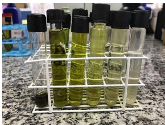
Figura 19: Pré extrações sucessivas com etanol
