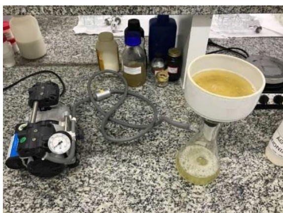
Figura 22: Filtração à vácuo para eliminação de partículas finas
