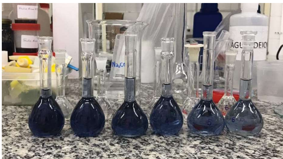
Figura 37: Método analítico para quantificação de fenóis totais via reagente Folin
