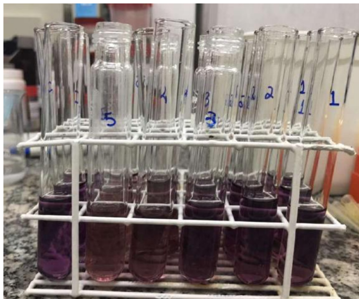
Figura 38: Tubos com amostra e DPPH designados à leitura no espectrofotômetro
