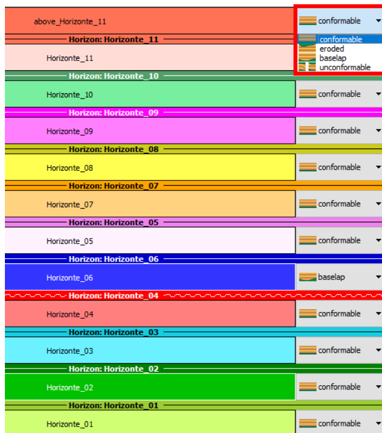
Figura 23 - Exemplo de coluna estratigráfica para construção de um modelo no SKUA-GOCAD, com destaque para as opções de relação entre os horizontes (destacado em vermelho).
