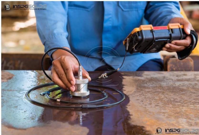
Figura 9 - END por ultrassom. Fonte: Disponível em [https://inspesolda.com/ensaios-por-ultrassom/?amp&gclid=CjwKCAiAi4fwBRBxEiwAEO8\\_HvORFo6xXFnu4KFFEEFiO5heNo9OS9NIJLc\\_mnlMph4xTiEmX02CW2RoC6E0QAvD\\_BwE](https://inspesolda.com/ensaios-por-ultrassom/?amp&gclid=CjwKCAiAi4fwBRBxEiwAEO8_HvORFo6xXFnu4KFFEEFiO5heNo9OS9NIJLc_mnlMph4xTiEmX02CW2RoC6E0QAvD_BwE). Acessado em 24/12/2019 às 18:59
