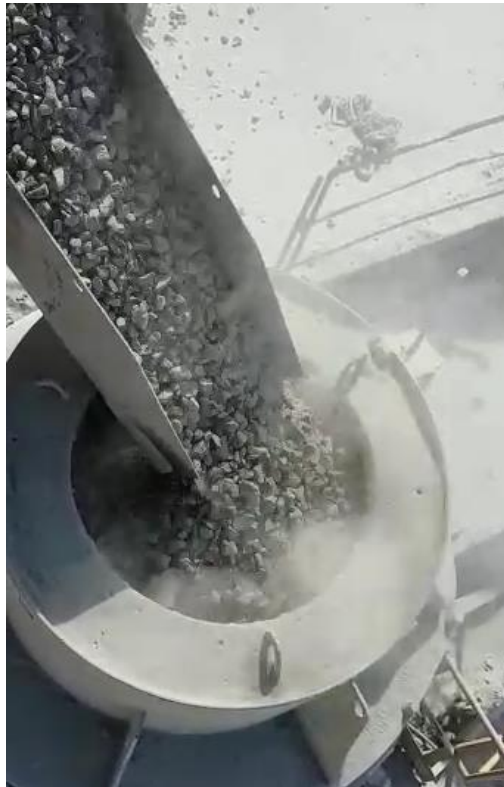
Figura 3.4-Alimentação do britador tipo VSI.
