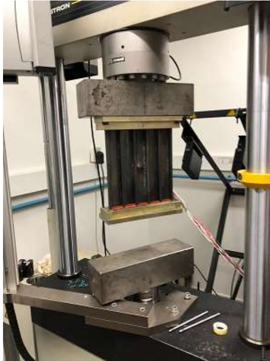
Figura III.8 – Aparato utilizado para os testes nos painéis
