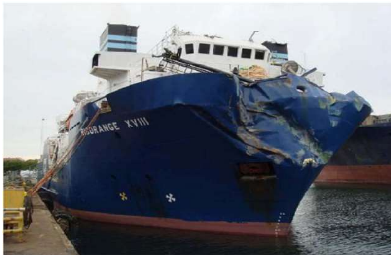
Figura II.1: Proa do Big Orange XVIII após uma colisão [16]
