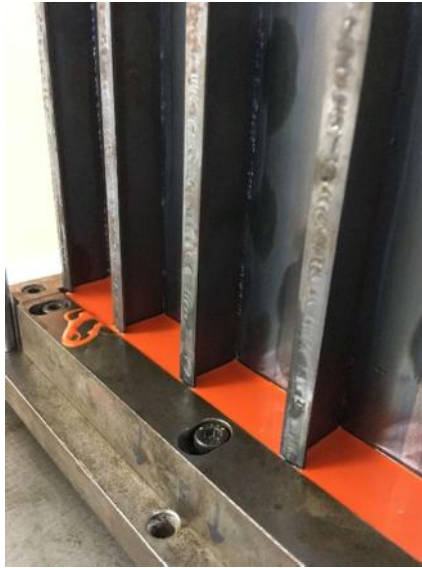
Figura III.1 – Painel com seus reforços fixados na base provisória para solidificação da resina
