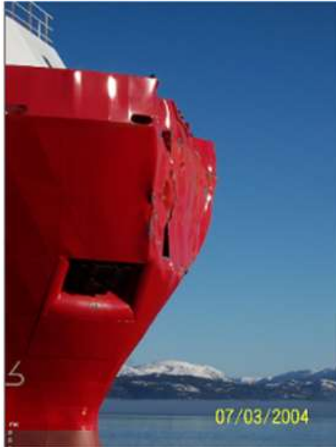
Figura II.2: Proa do Supply Vessel Far Symphony após colisão com uma plataforma offshore [19]
