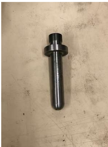
Figura III.7 – Indentador semi-esférico com 17,5 mm de diâmetro, utilizado para a indentação dos painéis P1A e P1B.
