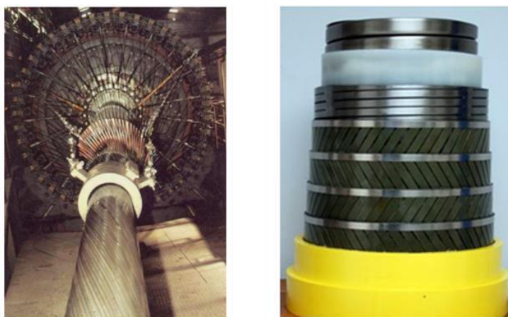
Figura 14 – (a) Processo de armagem [17]; (b) Duto flexível com armadura em fibra de carbono [19]
