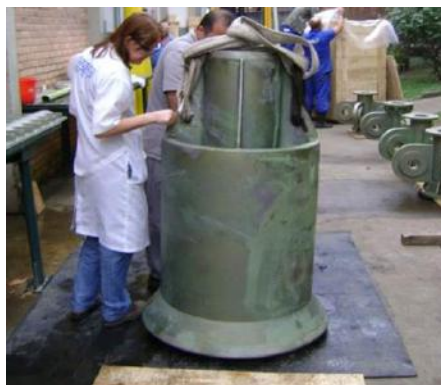
Figura 26 – Inspeção do suporte metálico após a fabricação [29]
