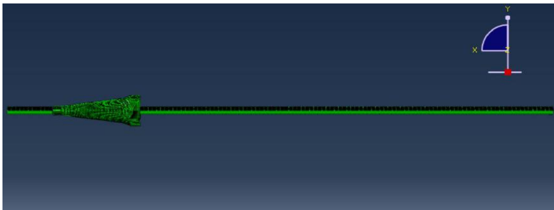
Figura 78 – Malha do enrijecedor à flexão com geometria complexa e do riser na configuração I-tube
