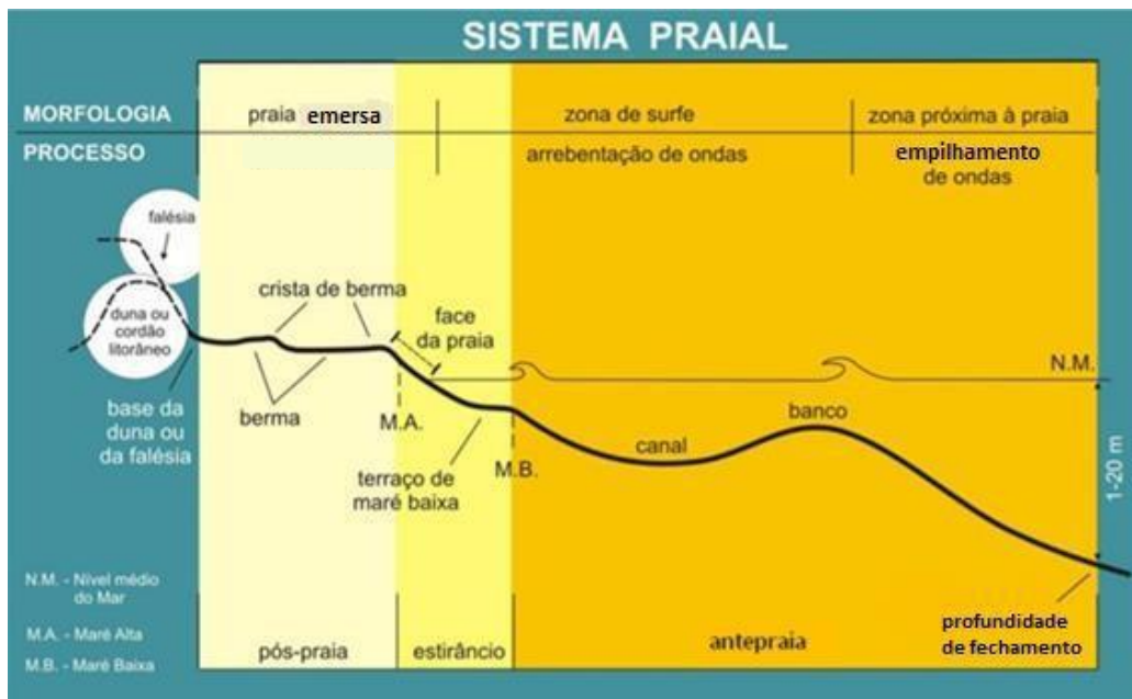
Figura 5. Esquema ilustrativo das feições morfológicas normalmente encontradas em uma praia arenosa do tipo intermediária (modificado de SOUZA et al. , 2005).
