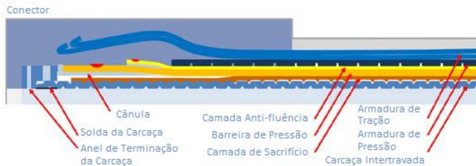
Figura 2.7: Riser flexível com liner multicamadas [10].
