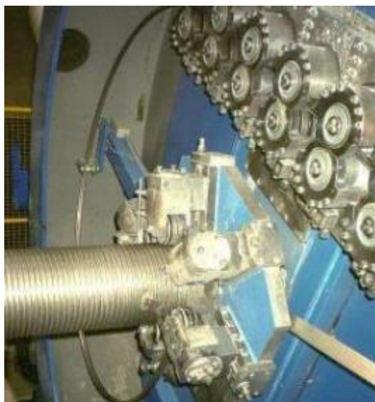
Figura 2.6: Fabricação da carcaça pelas unidades de perfilagem e de enrolamento helicoidal [20].
