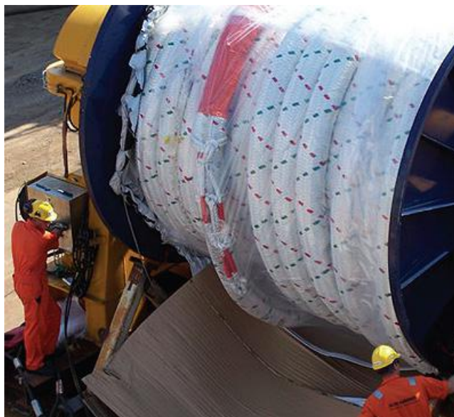
Figura 2.10: Exemplo de pennant sintético utilizado em aplicações offshore (fonte: energy-oil-gas.com).
