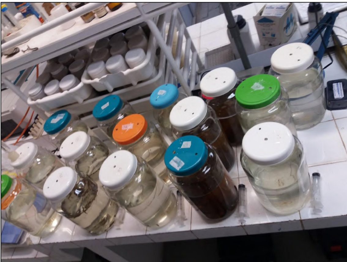
Figura 47 - Mesocosmos preparados, enriquecidos e inoculados. As colunas de réplicas, da esquerda para a direita, respectivamente, contêm as seguintes frações: sem fitomassa (controle), serrapilheira, folhas, casca, galhos finos. Fotografia após 3 h do início do experimento.
