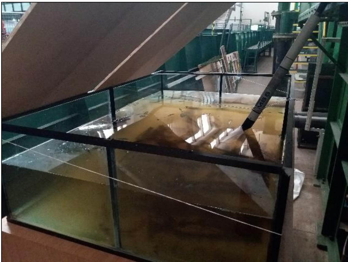
Figura 50 - tanque de decomposição integral, durante o quarto dia de experimento, já com a sonda estacionária instalada.
